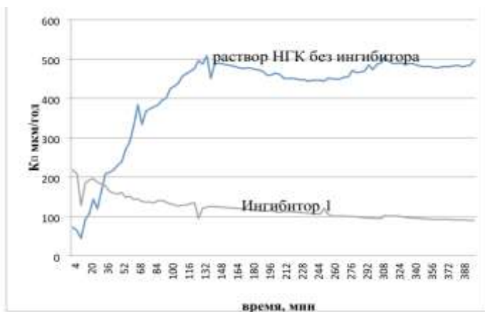
Рисунок 2 – График зависимости скорости равномерной коррозии K_p (мкм/год) от времени T (мин) в 5 % растворе НГК (холостой опыт) и с добавлением ингибитора-1 для стали Ст.3
